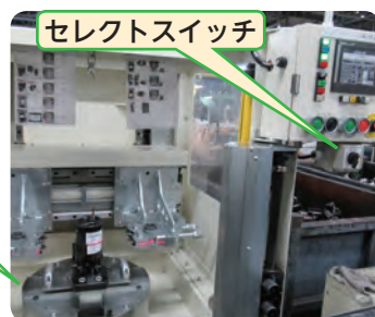
アキュームレーター分離装置
