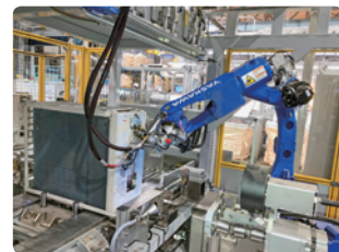
フロン自動回収システム
