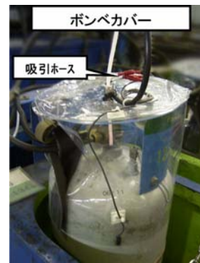
ポンベ上部に透明のカバーを取付けることで、微量な漏洩も検知
