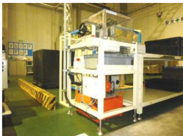
銅線切断装置全景
