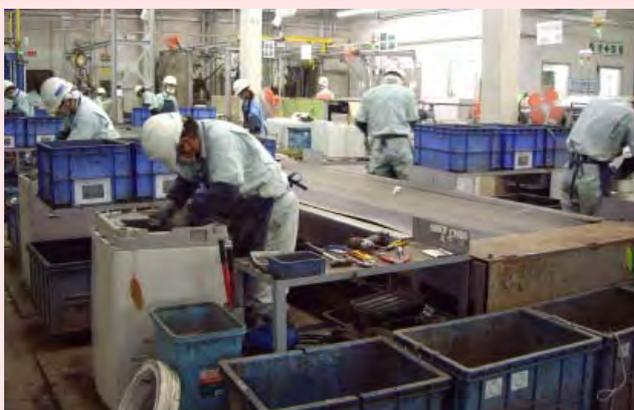
KRSCでは、冷蔵庫以外はセル方式で手解体を行っている。限られたスペースにおいて処理量を確保するために、最も効率の良い方法として採用している。
