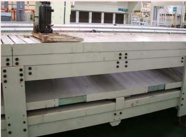
HCSでは、コンベアの搬送板に、一定のすきまを空けており、ごみ等がコンベアの下に設置されたごみ受け皿に落ちる仕組みになっている。ごみを回収しやすいように、ごみ受け皿は斜めに設置されており、一日の業務終了時に、清掃を行っている。
