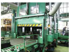
テレビ処理ラインの粉塵除去装置
