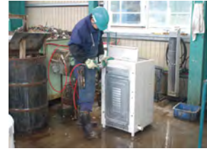
洗濯機手解体による 資源の分別回収作業
