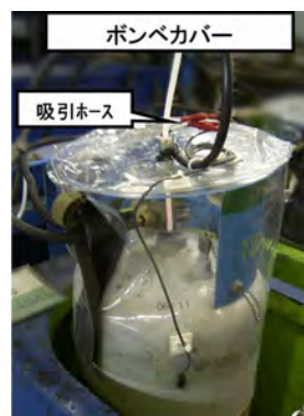
ポンベ上部に透明のカバーを取付けることで、微量な漏洩も検知
