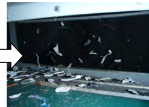
被覆配線が選別され吹飛ばされている様子
