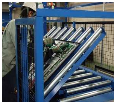
写真1： 傾斜や反転が可能な作業台が設置されたことにより、薄型テレビを効率よく処理できるようになった
