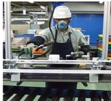
写真1： 傾斜や反転が可能な作業台が設置されたことにより、薄型テレビを効率よく処理できるようになった
