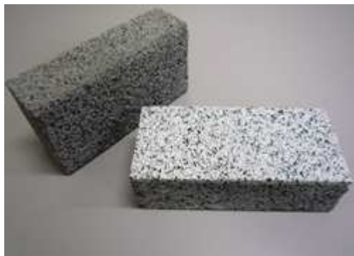
写真1： 使用済みブラウン管パネルガラス入り の舗道用ブロック拡大写真
