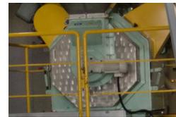
断熱材用ウレタンの固形燃料化装置。冷蔵庫の断熱材に使用されるウレタンからフロンを取除き、固形燃料を生成する技術を3年をかけ開発した。
