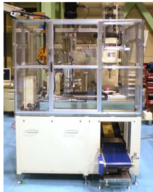
自動解体装置
