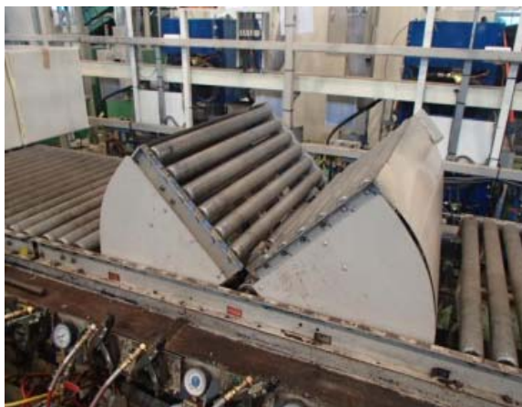
コンベヤ左右が回転駆動する
