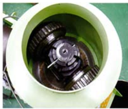
造粒機内部 (*実機はローラー4個構成)
