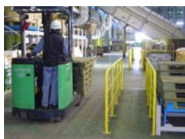
歩行者安全柵の設置
