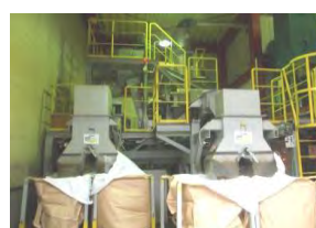
浮沈選別装置
