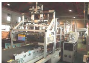
液晶・プラズマテレビねじ取り装置
