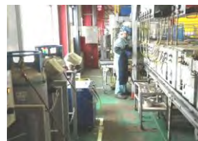
エアコンフロン回収ライン
