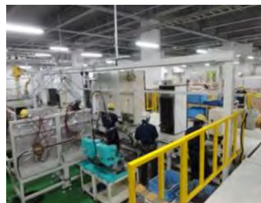
新ライン：パレット搬送による手解体工程
