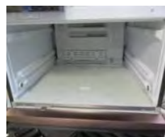
冷凍室奥側冷気吹き出し口
