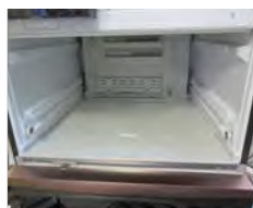
冷凍室奥側冷気吹き出し口
