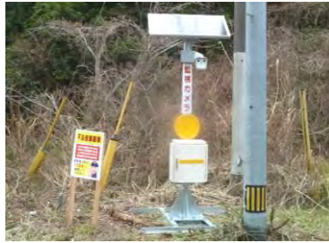
可搬型監視カメラ
