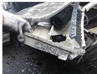
エアコン室内機の破損品
