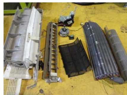
分解・仕分け後の室内機の状態
