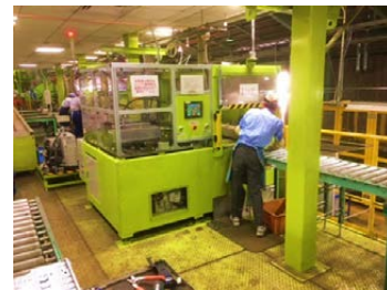
室内機プレス切断工法ライン
