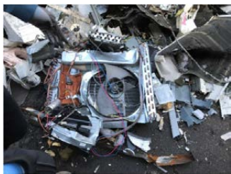
ミックスメタルスクラップに混入したエアコン室外機の破損品
