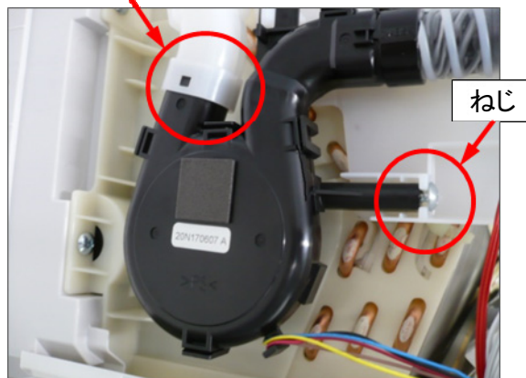
固定用ねじを削減したエアコン室内機換気ファンユニット例
