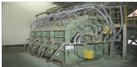
ノズル式消火噴水装置付き粗破碎機
