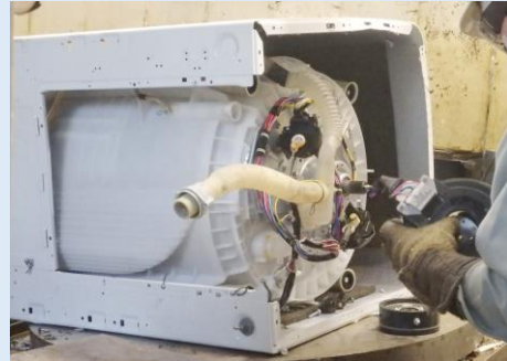
③洗濯機のモーターを取り外します。
