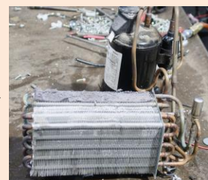
② ヒートポンプユニット内の熱交換器・コンプレッサの配管から冷媒フロンを回収します。
