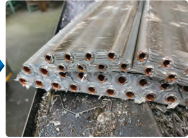
切断後の断面
