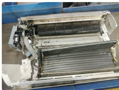
両端面を切断し、反転ユニットから出た状態
