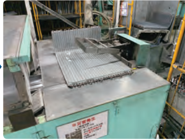
切断機で切断
