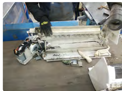
切断後の手解体作業
