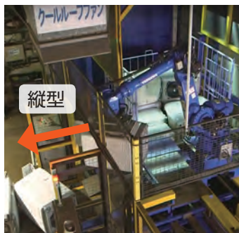
縦型用ラインとドラム式用ラインへの振り分け
