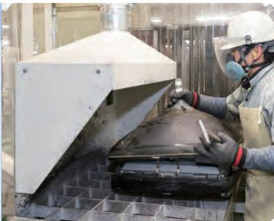
破碎・洗浄（破碎洗浄装置）
