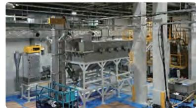
導入中の浮沈選別装置
